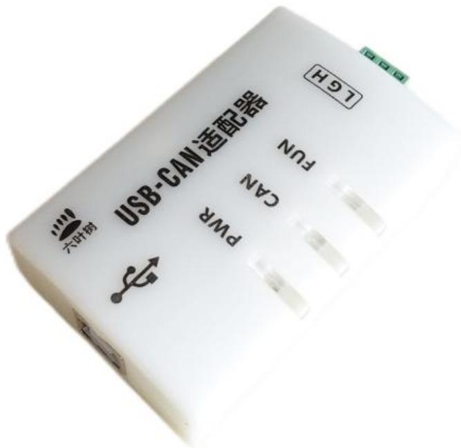
USBCAN1 自带电气隔离模块，可以避免由于地环流的损坏，增强系统在恶劣环境中使用的可靠性。
